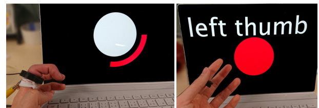
図1 提案システムのプロトタイプ: 左) 指の曲げ, 右) タッチした手を認識
