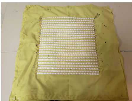
図 9 デバイス内部の LED テープライト
