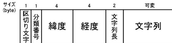
図 2. 詳細データファイルのレコード構造
