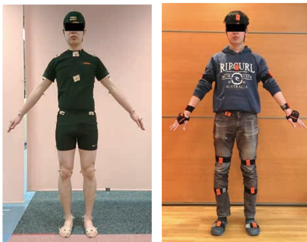
■ 図-1 光学式モーションキャプチャ (左) と IMU センサを用いた運動計測 (右) の様子
