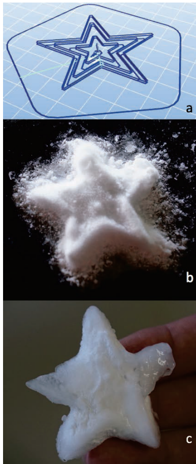
図 11 氷の星の造形工程 Fig. 11 GCode of the star used for printing.
