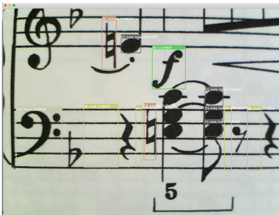
図 4 SSD-MobileNet による認識時の様子。フラット記号や和音符頭箇所が検出できていない。
