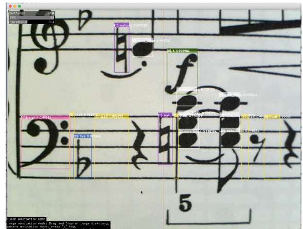
図 5 Yolo.v2-tiny による認識時の様子。ある程度検出はできているが、フォルテシモ直下のドの符頭位置が大きくずれている
