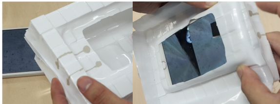
図 13 タッチセンサ(ヘッドマウントディスプレイ) Fig. 13 HMD touch sensor.
