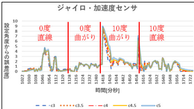
図 8 ジャイロ・加速度センサの実験結果 ( c = 3, 3.5, 4, 4.5, 5 ) Fig. 8 Experimental results of gyro and acceleration sensor ( c = 3, 3.5, 4, 4.5, 5 ).
