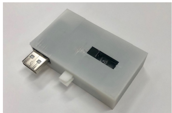
図 3 タブレットの動きを読み取る装置 Figure 3 Apparatus that reads tablet motion
