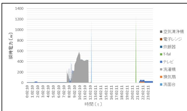
図 14 収集対象機器全体での瞬時電力
