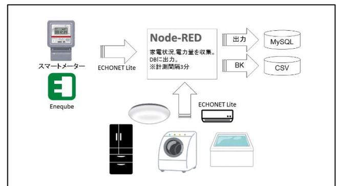
図11 実験(2)のデータ収集システム
