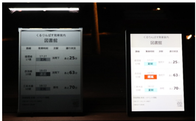
図 11 夜間の視認性の比較 (左: 電子ペーパー, 右: タブレット PC)
