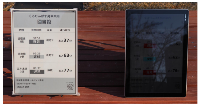
図 10 屋外での視認性の比較 (左: 電子ペーパー, 右: タブレット PC)
