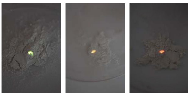
図 20 ガラス蛍光体粉末とその発光 Figure 20 Glass phosphor powder and light emission.
