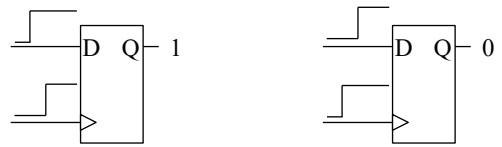
図 3 アービター回路でのレスポンス生成 Figure 3 Response generation in arbiter circuit.
