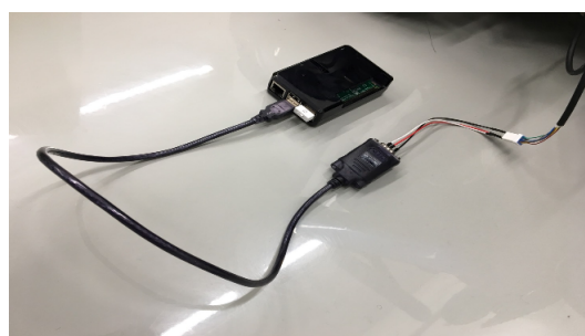
図 3: WHILL Model CR と Raspberry Pi 3 の接続
