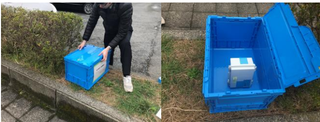
図7 社宅に設置した簡易地震計の様子
