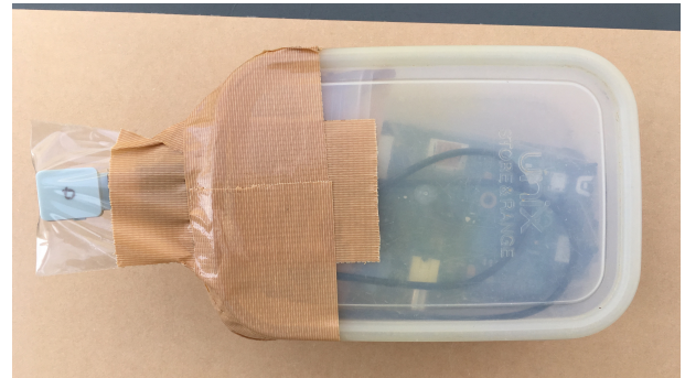
図 5 防水ケースに入れた実験用浮流端末と外部に固定したアンテナ
