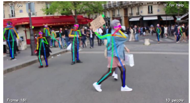
図1 Open Poseによるボーン検出
