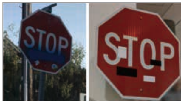
■ 図-3 攻撃者が停止標識にスプレーやテープを貼ることにより、標識を認識させなくすることができる（文献1）から引用
