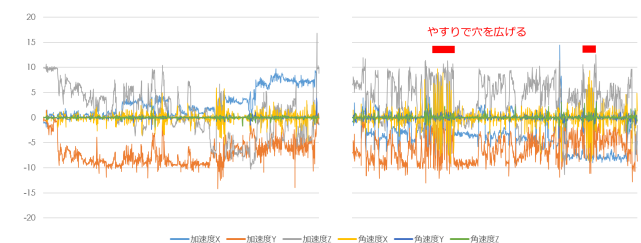
図 7 3D プリントモンスターのモーションデータ例。やすりを利用する際に、利き手の角速度 X に大きな振幅が見られる。
