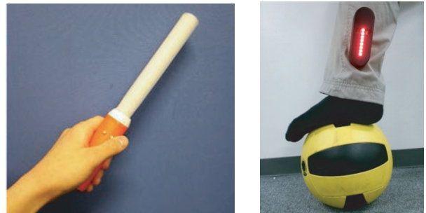
図 4 左: Across Penlight (観客側デバイス), 右: Across Gear (プレイヤー側デバイス)
