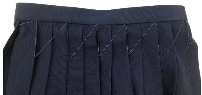
図 6 スカートのウエストへのノコギリ縫い
