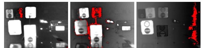
図 11 それぞれのターゲットにおける同一距離の推定結果. 図 10 に示した赤点と同一距離と推定された領域を赤色に示す.
