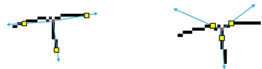
図 7 交差点の近くのピクセルを利用してベクトルを生成したときの問題点。左: 角度特徴の抽出に使用する理想的なベクトル。右: 交差点の近くのピクセルを利用して生成したベクトル。
