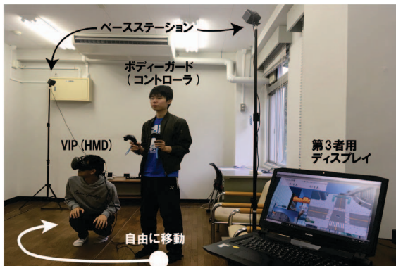
図4 「ザ・ボディーガード」のシステム構成
