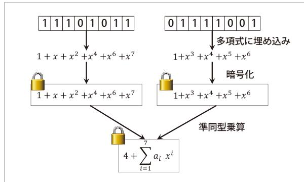
■図-4 多項式パッキングを用いた内積計算
