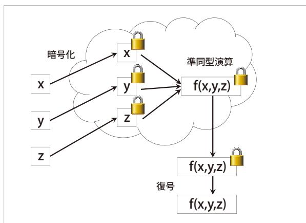
■図-1 準同型暗号を用いたクラウド上の計算
