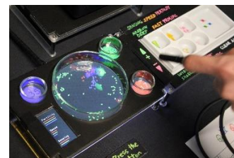
図2 シャーレ型フィジカルMRディスプレイ Figure 2 Petri dish MR display
