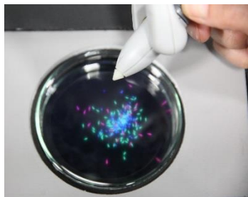
図 9 バーチャル魚群との力覚インタラクション Figure 9 Haptic interaction with virtual schooling fish
