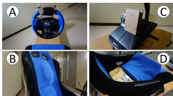
図 2 振動子の取り付け位置詳細
