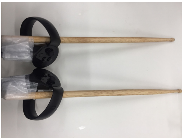
図 4 Oculus Touch を取り付けたドラムスティック Fig. 4 Oculus Touch with sticks
