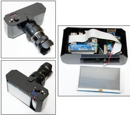
図 1: 構図推薦カメラ本体. (上) 正面, (下) 背面, (右) 内部
