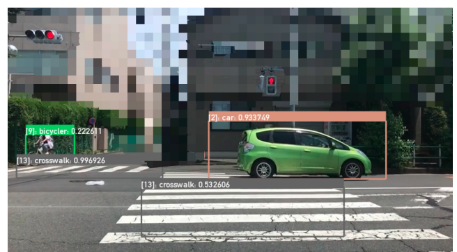
図 3 COCO のモデルと比較して, 自転車搭乗者を bicycler, 横断歩道箇所を Crossroad と正しく認識しているのがわかる. ただし, 横断歩道の信号に関しては認識できていない.
