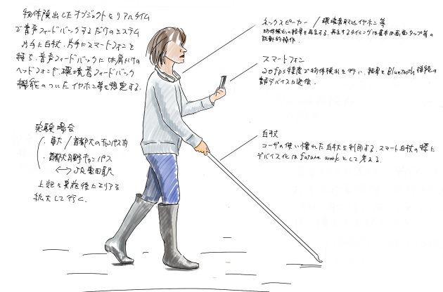
図 1 初期評価プロトタイプシステムのスケッチ。白杖を持ちながらスマートフォンをかざし、周辺情報は音声でフィードバックする
