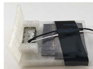
図 18 振動方式伝達機構
