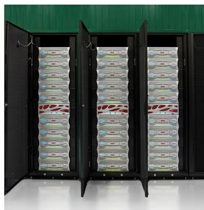
図6 ABCI大容量ストレージシステム
