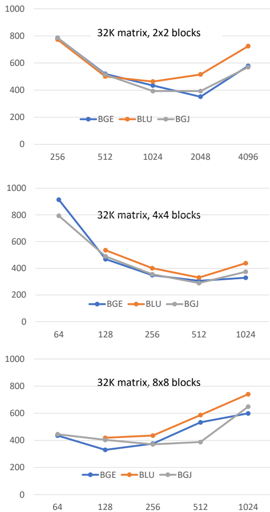
図 21 32k 行列・2×2, 4×4, 8×8 分割のときの、タスク毎のプロセス数に対する各アルゴリズムの実行時間の比較
