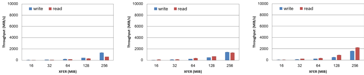
(a) "ストライピング" ( S_S=1 MiB) (b) "ストライピング" ( S_S=16 MiB) (c) "ノンストライピング" ( S_S=256 MiB)
