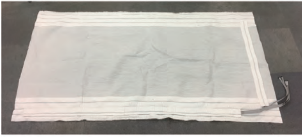
図 4 作成したシート型センサ
