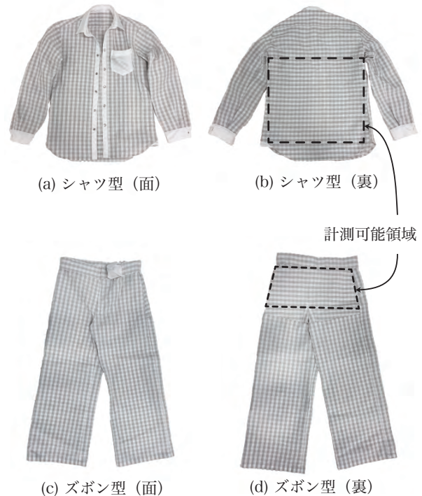
図 3 作成した衣類型センサ
