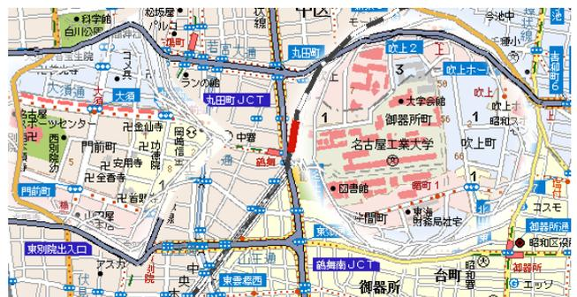
図5 Focus+Glue+Context マップの例。虫眼鏡のように注目したい領域を拡大表示すると同時に、注目領域と周辺領域が接続領域をゆがませることにより道路ネットワークが維持されている。
