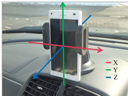
図 3 スマートフォンの設置環境とセンサの各軸の向き
