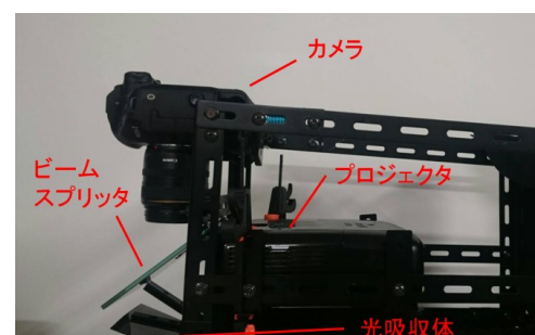
図2 構築した光軸一致のシステム
