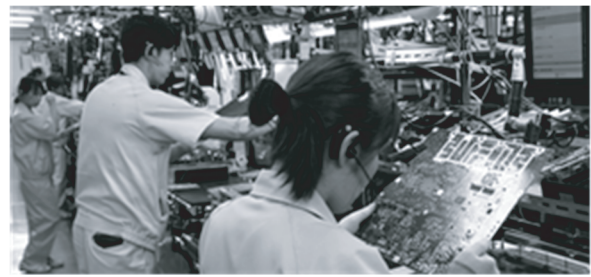
図 10 ハンズフリー化を実現した NEC プラットフォームズ福島事業所の組立検査工程
