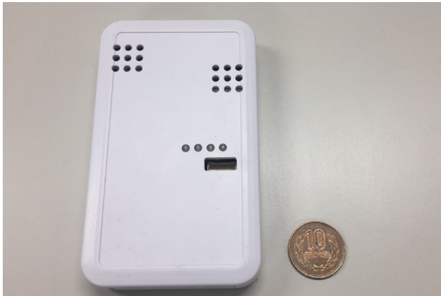
図 3 今回実験で想定された日本 GIT 社の IR-UWB タグ
