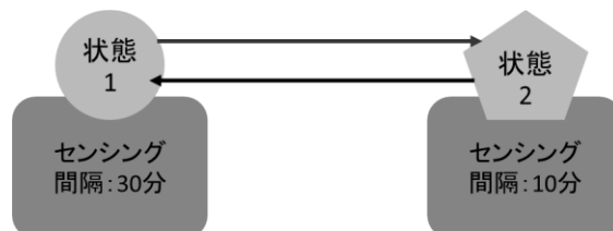
図 2. 状態遷移による動作変更の一例
