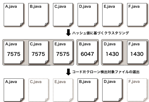
図 2 ファイルのハッシュ値に基づいたクラスタリング Fig. 2 Clustering based on file hash.
