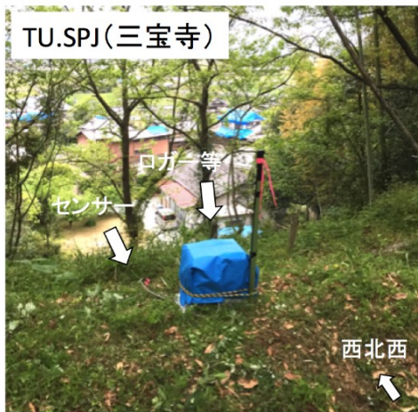
図4 携帯通信を用いた臨時観測点の例
