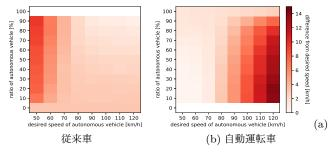
図 5 希望速度と走行速度の差の変化
