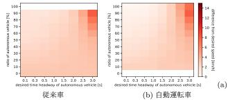
図 10 希望速度と走行速度の差の変化
