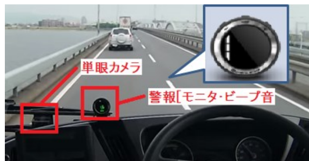
Figure 1. 衝突警報システム(Mobileye530)の車載例
