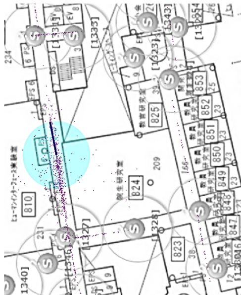
図 5 測位アプリケーションのスクリーンショット (水色の円の中心が測位結果, 青実線が進行方向, ピンクの点が各パーティクルの位置を示す)
