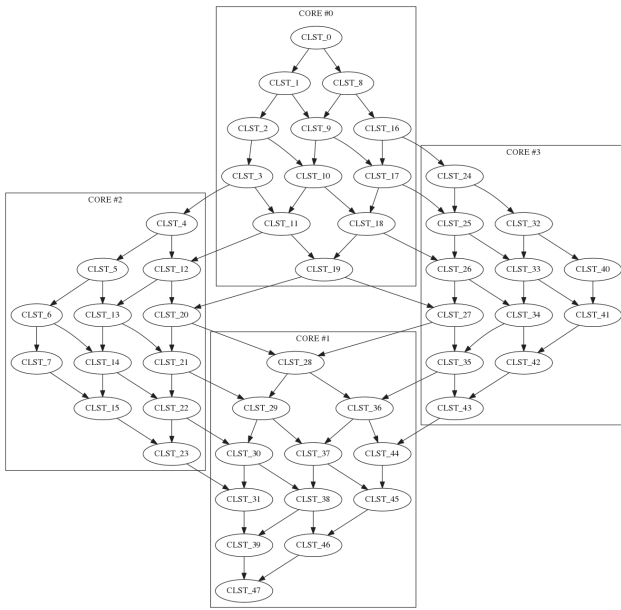
図 8 6 行*8 列 Mesh グラフ ( conn\_weight = 1 ) に対する提案手法の 4 コア割当て結果の図示
