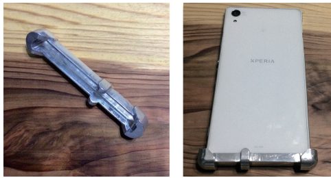
図 7 タッチケース (type C) (左) と type C を装着した Android 端末 (右)
