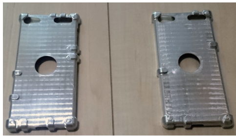
図 4 アルミ合金のタッチケース (type B) (左が 1 辺 4 点のタイプ, 右が 1 辺 3 点のタイプ)
