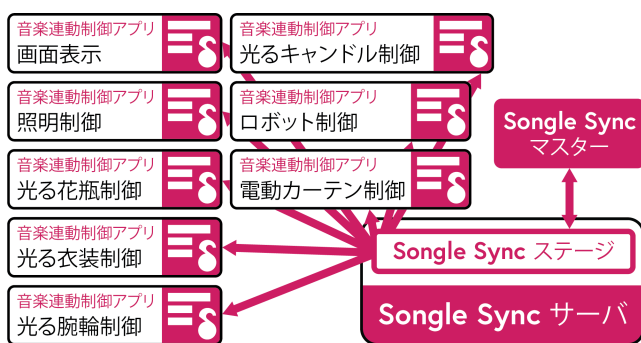
図7 多様な音楽連動制御アプリが利用されている状況でのシステム構成図
